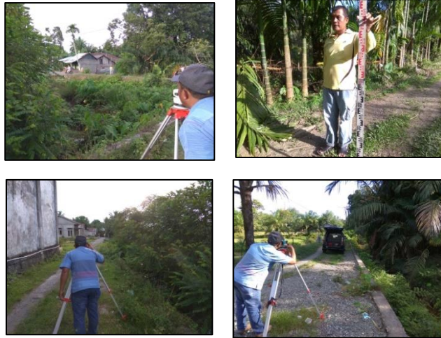
Gambar 12. Pengukuran beda tinggi ( Cross Section )
