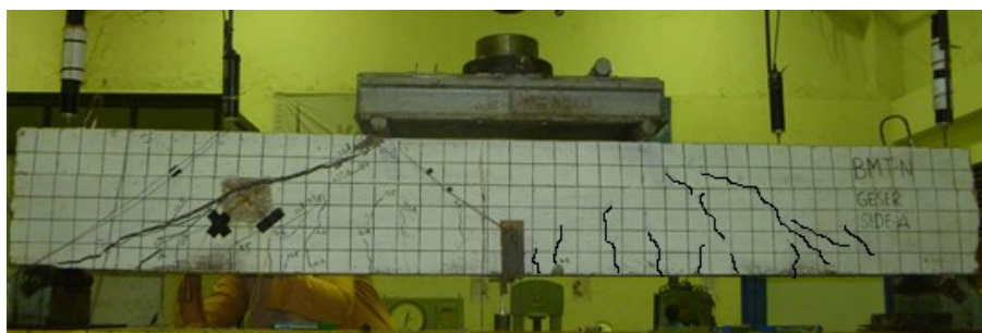
Gambar 4. Grafik Pola Retak Balok BMT-N
