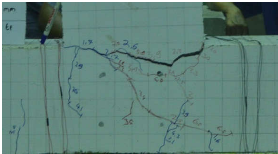
Gambar 7. Pola Retak beban Tekan (-), 24
