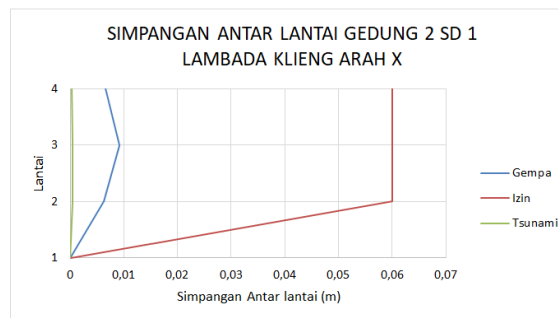
Gambar 14. Grafik simpangan antar lantai arah x Gedung 2 SD
