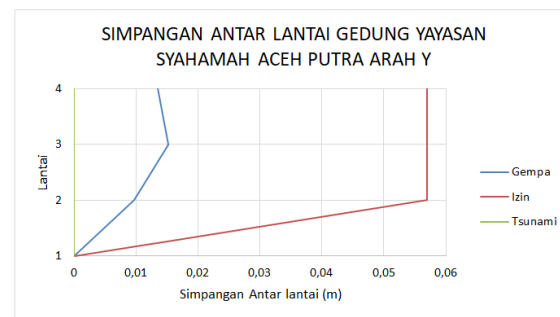
Gambar 17. Grafik simpangan antar lantai arah y gedung yayasan kesehatan masyarakat
