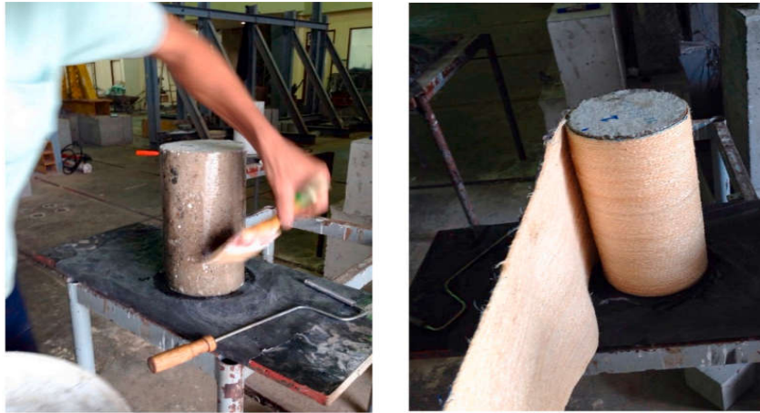
Gambar 2. Penempelan FRP serat sisal pada benda uji silinder Sumber : Yinh (2021)
