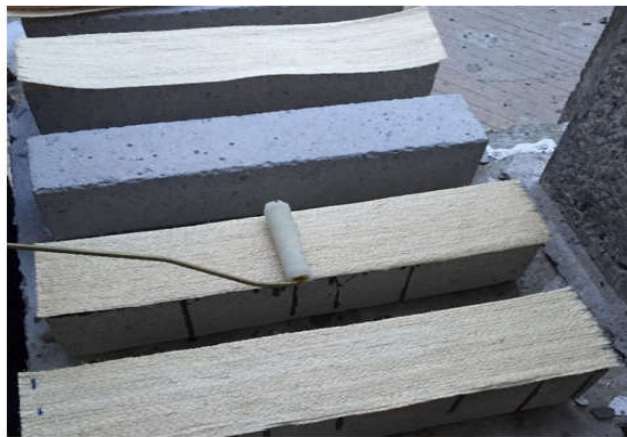
Gambar 3. Penempelan FRP serat sisal pada benda uji balok Sumber : Yinh (2021)
