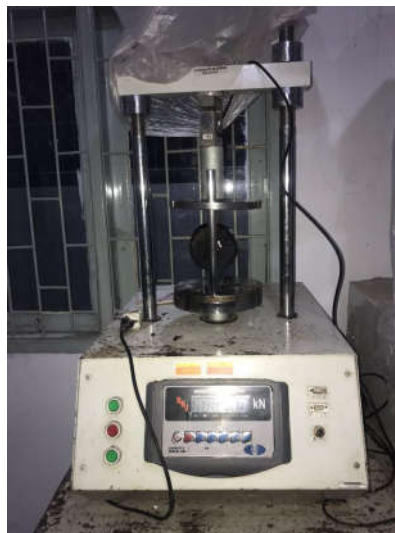
Gambar 2. Uji Kuat Tarik Tidak Langsung (ITS)
