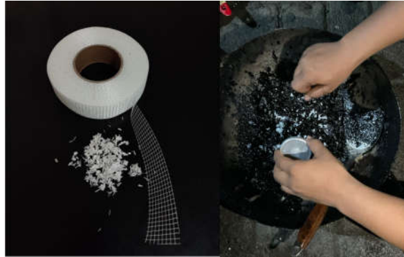
Gambar 1. Campuran Stone Mastic Asphalt dengan Fiber mesh
