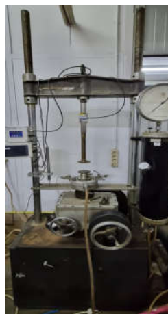
Gambar 4. Alat Uji Kuat Tekan Bebas
