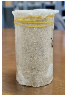
Gambar 3. Sampel Campuran Pasir Silika, Ragi Tempe, Terigu, dan Air Suling di Dalam Tabung Cetakan
