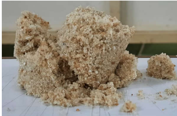
Gambar 8. Campuran Pasir Silika, Jamur RO 5%, Terigu 5%, Curing Hari ke-1
