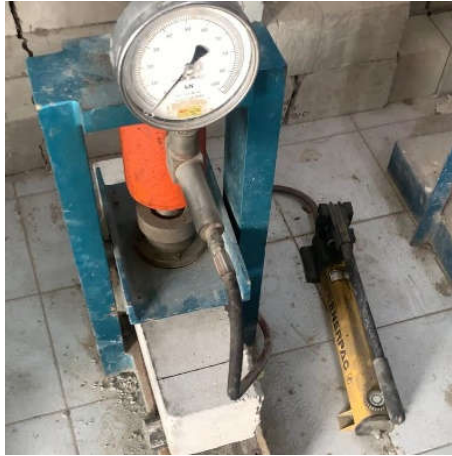
Gambar 5. Pengujian Kuat Lentur Beton
