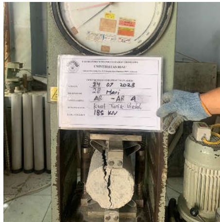
Gambar 4. Pengujian Kuat Tarik Belah Beton
