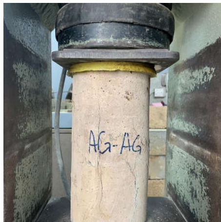
Gambar 3. Pengujian Kuat Tekan Beton
