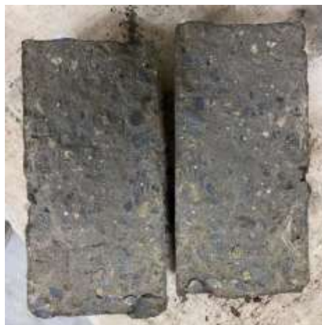
Gambar 10. Benda uji beton setelah uji tarik belah
