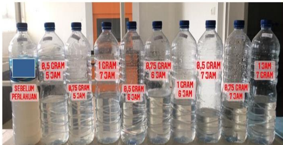
Gambar 3. Limbah Binatu sebelum proses fotodegradasi dan setelah proses fotodegradasi
