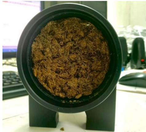
Gambar 3 Pengujian sampel: (a) skema tabung impedansi dan (b) pemasangan sampel uji
