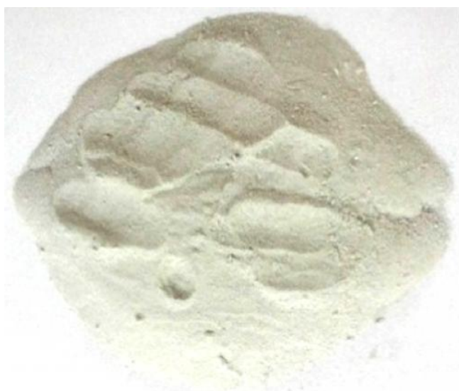
Gambar 2 Serbuk hidroksiapatit hasil sintesis dari tulang sapi yang telah dimilling menggunakan ballmill
