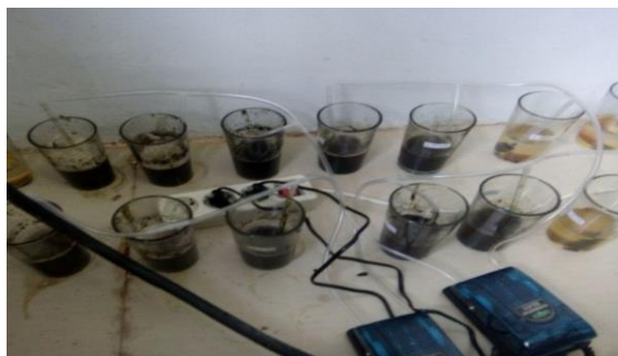
Gambar 2 Rangkaian Alat Uji Korosi
