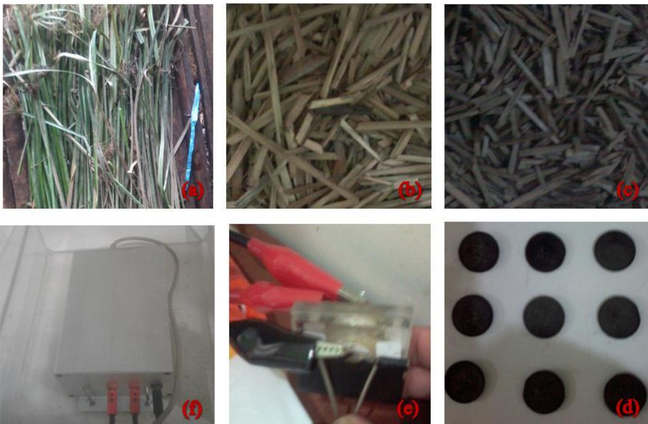
Gambar 1 Proses pembuatan elektroda karbon superkapasitor dari rumput PT dan pengukuran siklis voltammetri, (a) PT, (b) PT setelah dikeringkan, (c) PT terpra-karbonisasi, (d) Pelet karbon PT (e) sel superkapasitor, (f) siklis voltammetri
