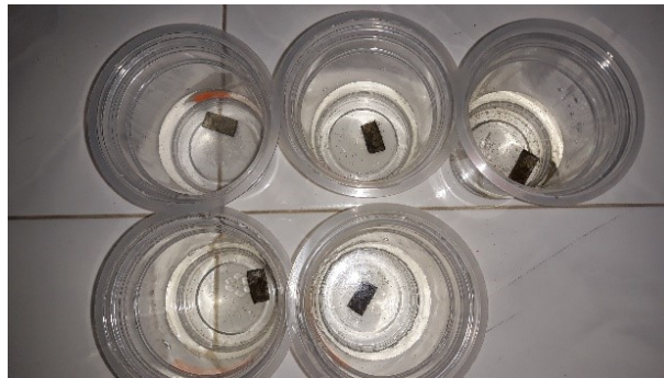
Gambar 6. perendaman plat besi dalam media korosif
