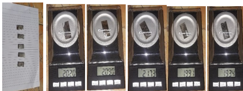
Gambar 5. Plat Besi Dijemur dan Ditimbang
