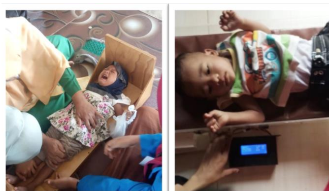
Gambar.4 Kiri, Proses pengukuran tinggi badan menggunakan alat ukur manual dan Kanan, Pengukuran tinggi dan berat badan menggunakan alat ukur status gizi otomatis yang terbaca pada LCD
