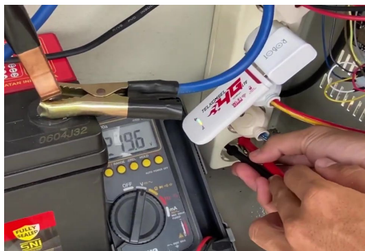
Gambar 8. Modem GSM 4G pada panel Box PTM
