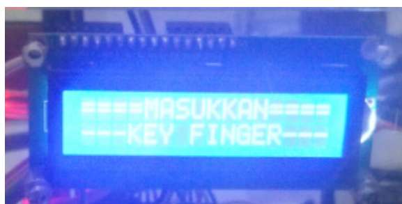
Gambar 11 Tampilan hasil sistem dan LCD ketika sensor passive infrared receiver tidak deteksi keberadaan user
