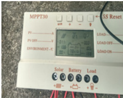
Gambar 5. MPPT 30 Ampere dengan output PWM
