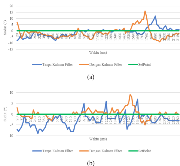
Gambar 25. Pengujian dinamis 7° (a) Sudut roll (b) Sudut pitch
