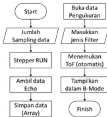
Gambar 4. Flowchart proses pengambilan echo hingga mendapatkan gambar B-Mode
