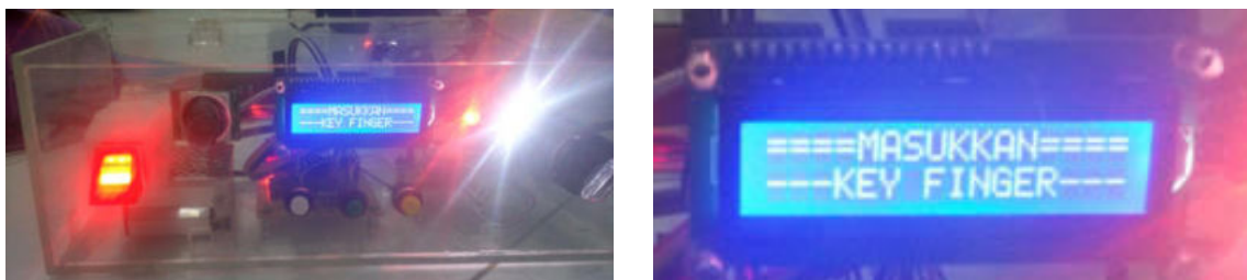
Gambar 12 Tampilan hasil sistem dan LCD ketika terdapat user , tetapi data sidik jari belum dimasukkan ke sensor fingerprint
