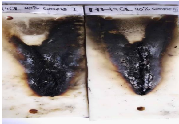
Gambar 9. Kondisi permukaan dialiri kontaminan \text{NH}_4\text{Cl}
