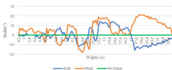
Gambar 16. Grafik pengujian dinamis 2 robot terhadap sudut roll dan pitch dalam keadaan standby
