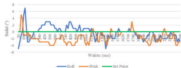
Gambar 18. Grafik kestabilan robot saat berjalan statis pada sudut roll -7°
