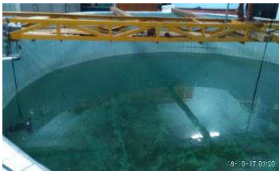
Gambar 13. Pengujian transmitter (kiri) dan receiver (kanan) di acoustic test tank Departemen Ilmu dan Teknologi Kelautan IPB
