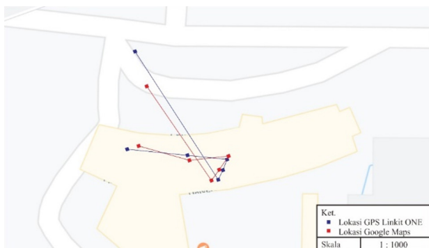
Gambar 9. Perbandingan data posisi GPS Linkit ONE
