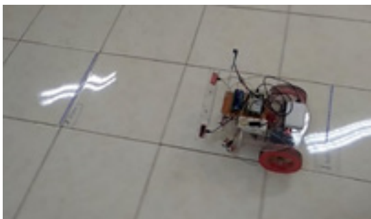
Gambar 7. Pengujian sensor rotary encoder untuk mengukur jarak tempuh
