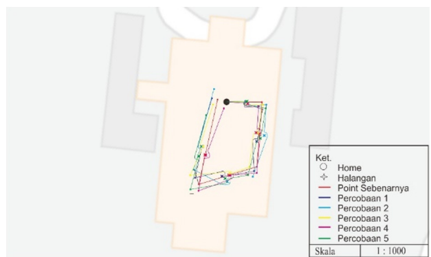
Gambar 13. Pengujian waypoint saat ada halangan atau lubang
