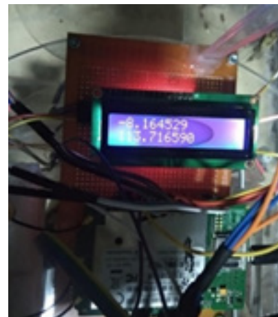
Gambar 10. Pengambilan latitude dan longitude GPS Linkit ONE
