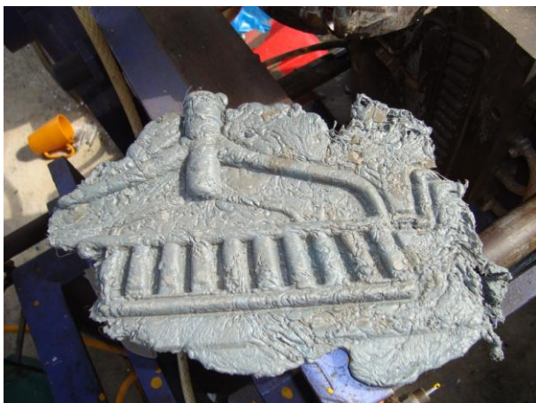
Gambar 3. Kegagalan produk hasil cetakan injeksi molding pada pabrik pengolahan limbah plastik.
