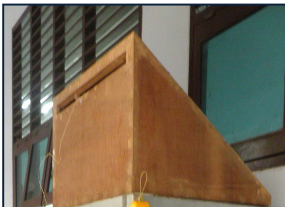
Gambar 4. Cerobong asap dengan sudut atap 25o
