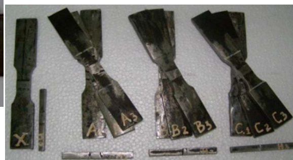
Gambar 5. Spesimen-spesimen uji tarik dan uji kekerasan
