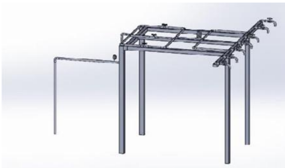
Gambar 2. Alat Uji pemipaan dalam bentuk tiga dimensi
