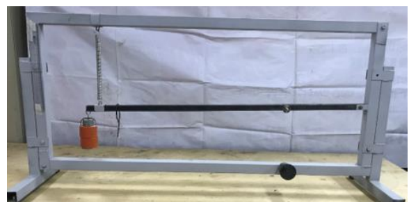
Gambar 4. Setup alat uji untuk simulasi getaran bebas
