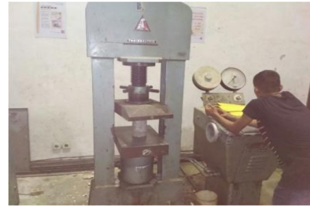
Gambar 2. Proses Uji Tekan Material Komposit
