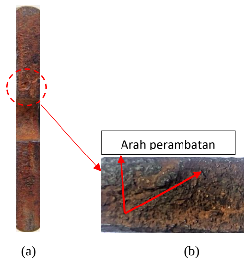
Gambar 3. Struktur makro pegas daun, (a) permukaan patah pegas daun, (b) Initial crack
