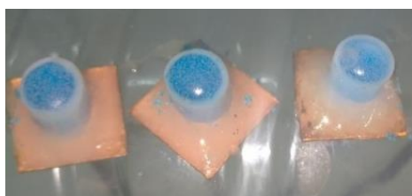
Gambar 2. Pembuatan porous plug elektroda
