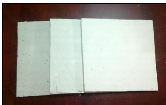
Gambar 2. Spesimen Uji Ketahanan Air.
