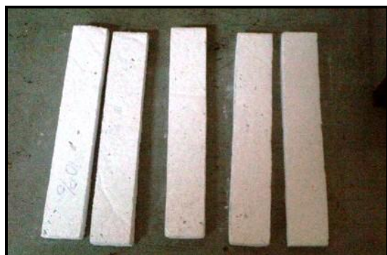
Gambar 1. Spesimen pengujian fleksural.
