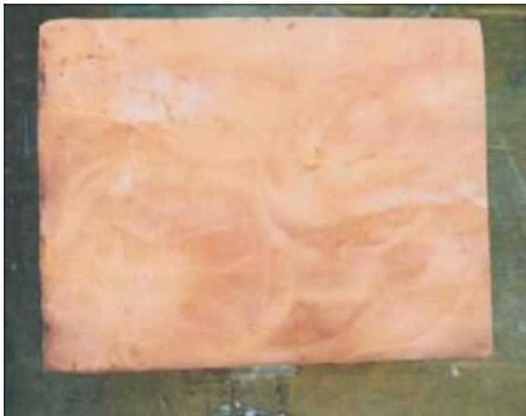
Gambar 2. Komposit dengan penguat serat buah biduri
