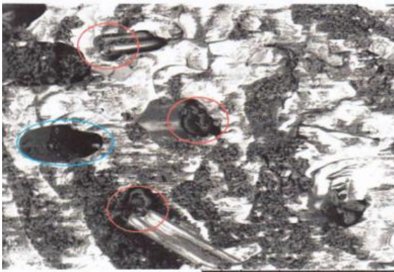
Gambar 12. permukaan hasil pemotongan dengan drilling dengan menggunakan material serat buah biduri.
