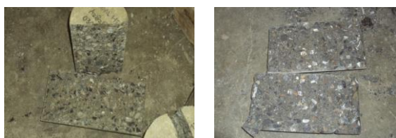
Benda uji beton campuran air dingin Benda uji beton campuran air panas Gambar 7 Pola kehancuran beton dengan air campuran suhu ekstrim
