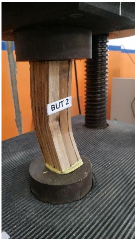
Gambar 7. Keretakan Benda uji Tekan
