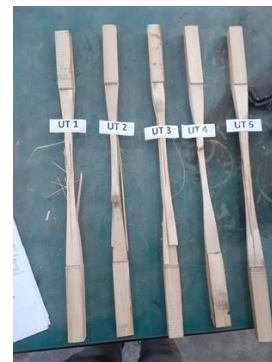
Gambar 10. Benda uji Kuat Tarik Setelah Pengujian
