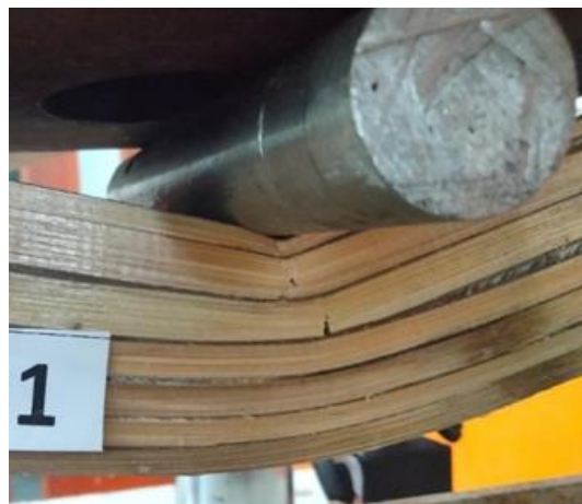
Gambar 14. Retak Akibat Tekan
