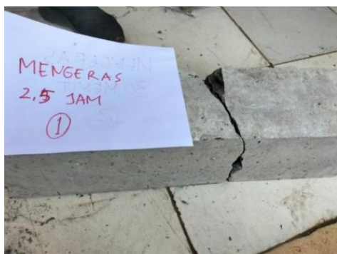
Gambar 12 Hasil Uji Lentur Fase Setting
