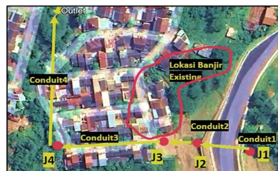
Gambar 6. Detail posisi banjir dan jaringan drainase eksisting jalan Jangli
