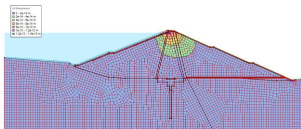
Gambar 14 . Displacement Maksimum Tubuh Bendungan STA 0+500
