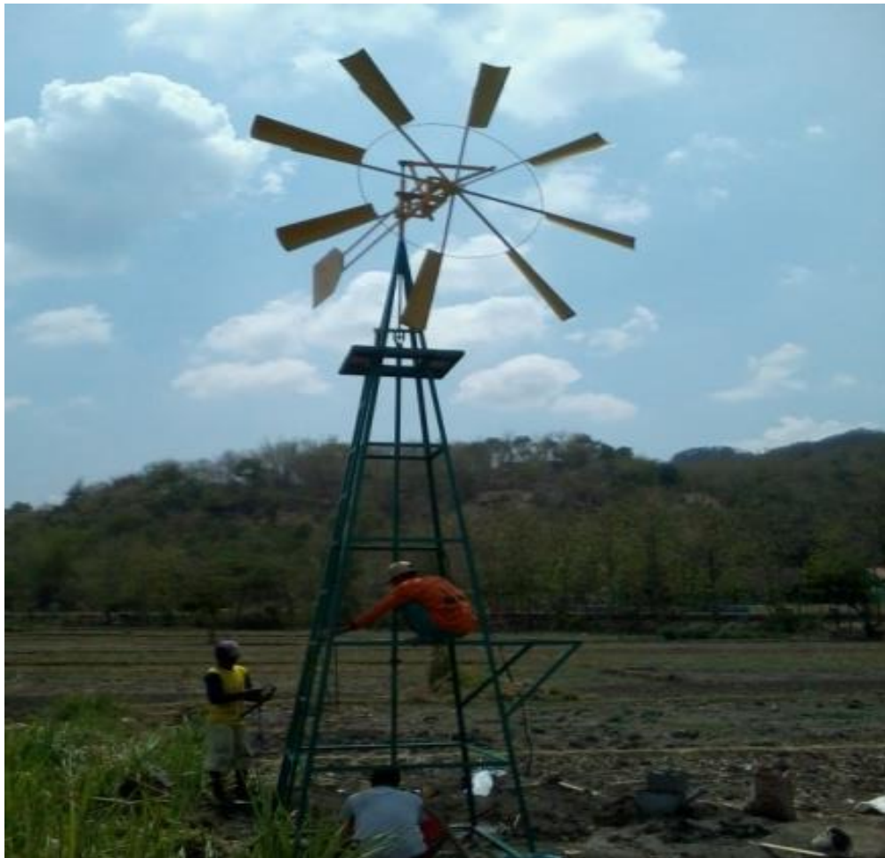
Gambar 2. Kincir angin penggerak pompa (Nur Untoro, 2015)
