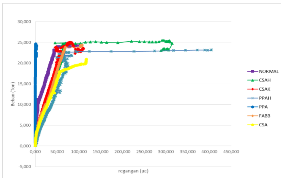
Gambar 9. Grafik Hubungan Beban- Regangan Baja Tarik Terhadap Variasi Aditif dan Subtitusi Agregat
