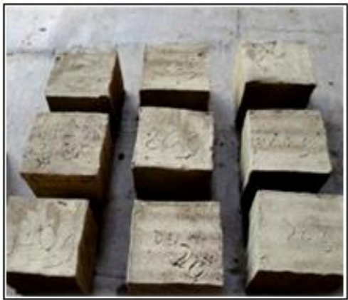
Gambar 2. Pasta komposit clay-Fe 3 O 4 /ASP yang telah dicetak dan dikeringkan di udara
