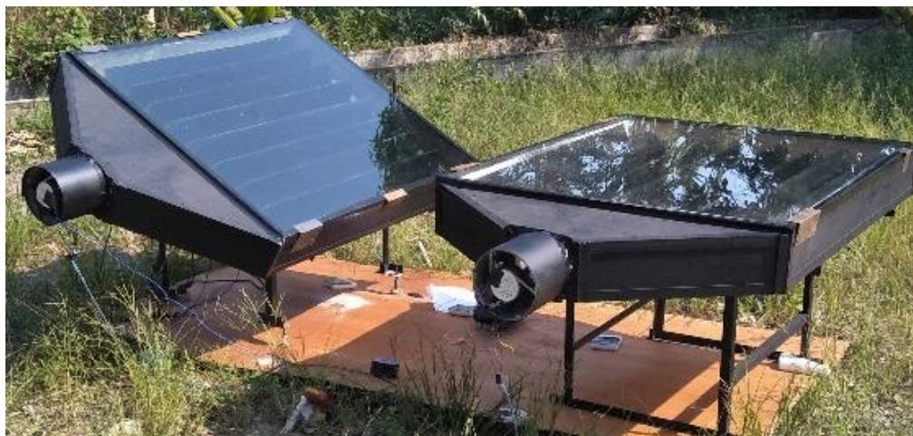
Gambar 2. Kolektor surya yang dapat bergerak mengikuti arah matahari
