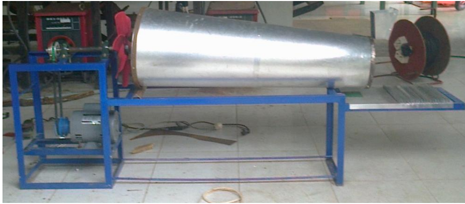
Gambar 1. Hasil konstruksi prototipe mesin pembersih gabah
