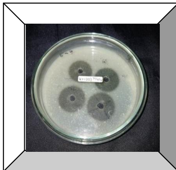
Gambar 2. Aktivitas proteolitik pada media Skim Milk Agar (SMA) menggunakan metode sumur pada 2 x 24 jam
