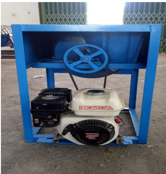
Gambar 3. Mesin perajang porang
