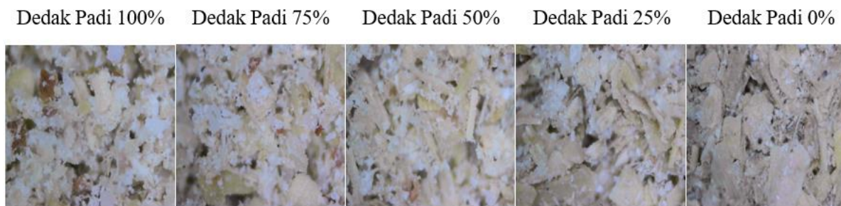
Gambar 6. Bentuk Partikel Dedak Padi Berdasarkan Persentase Campuran Sekam Menggunakan Mikroskop
