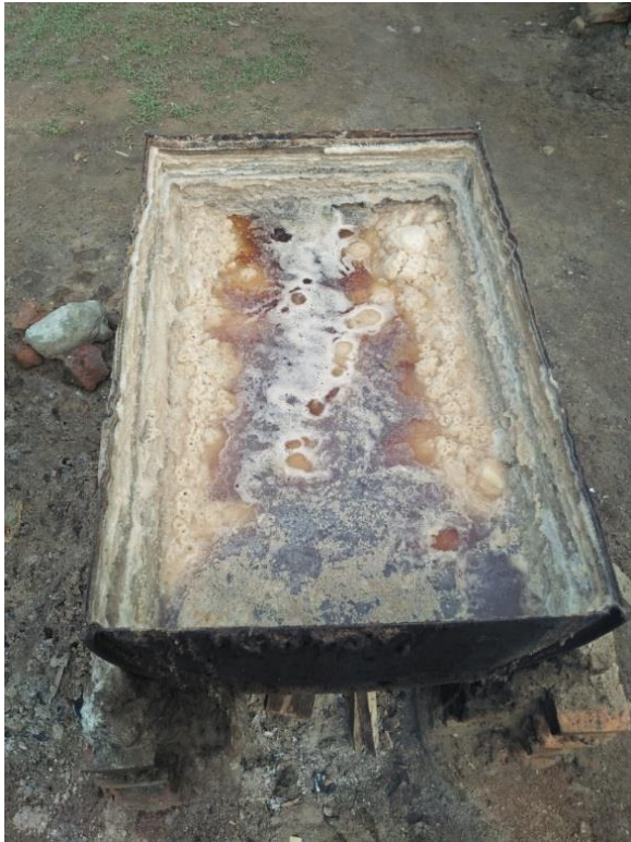
Gambar 2. Proses perebusan air tua menjadi garam
