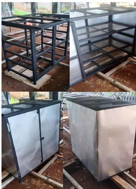
Gambar 3. Alat pengasapan ikan
