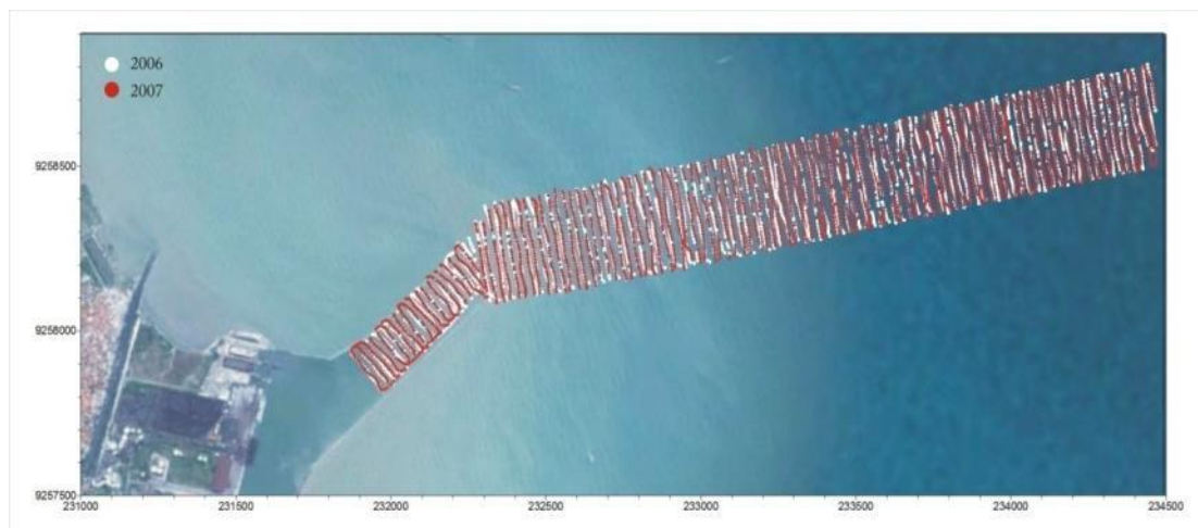
Gambar 2. Track Survei Batimetri di perairan Pelabuhan Cirebon, Jawa Barat.
